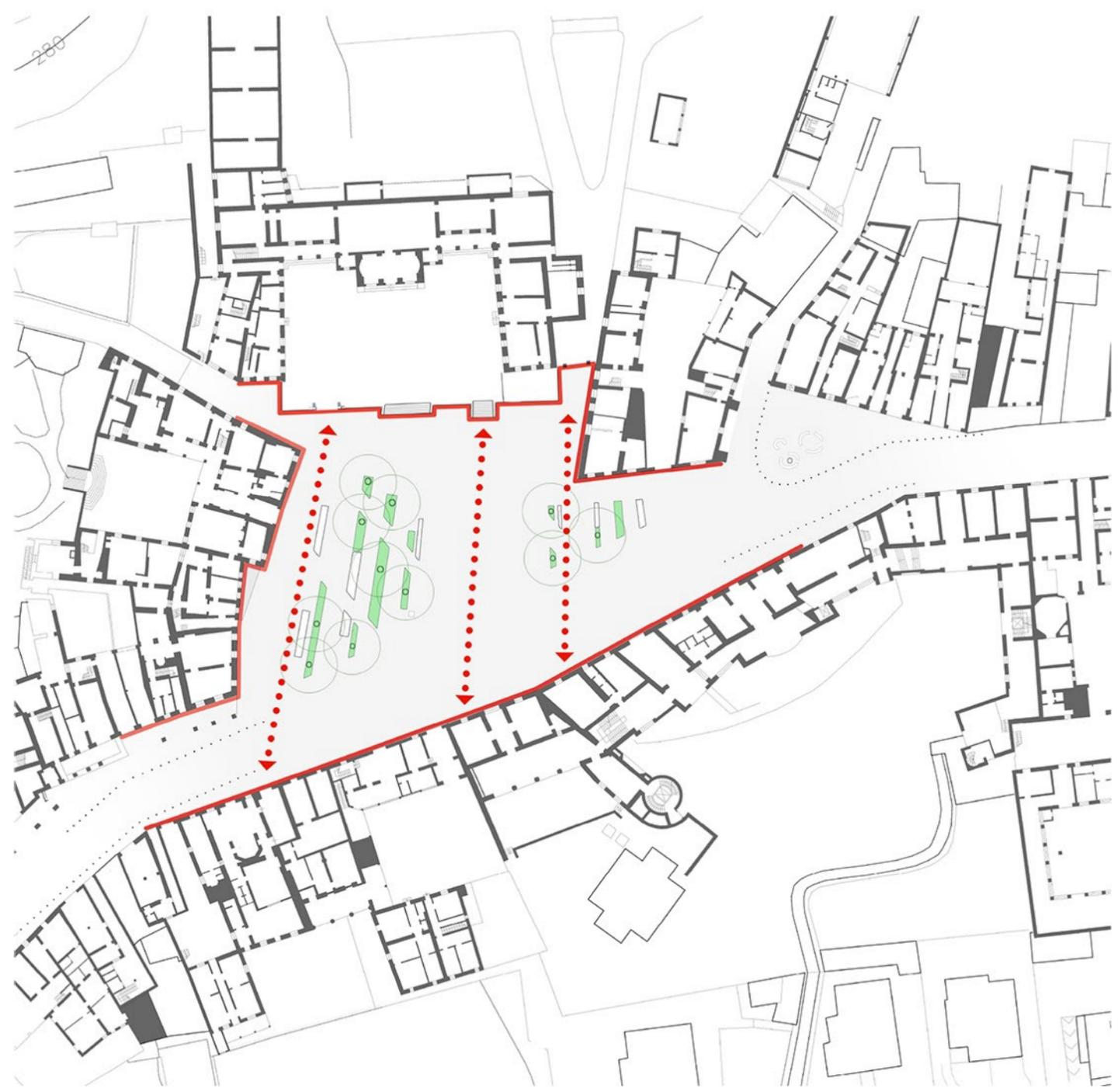
L'integrazione della strada nel disegno globale della piazza è reso possibile dall'inserimento di segni paralleli alle tracce principali, più fitti ed equidistanti per l'inserimento di dissuasori a protezione dei pedoni e dell'illuminazione.
