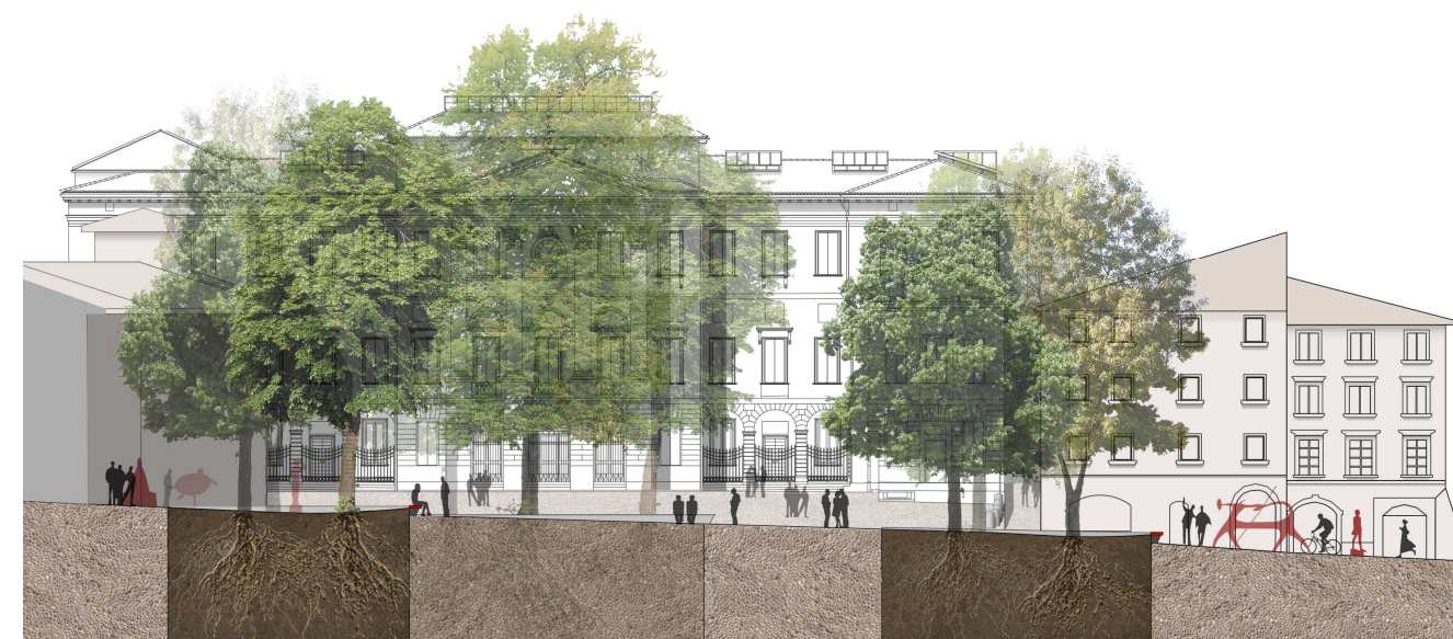
salvaguardia e valorizzazione delle alberature esistenti – protezione degli apparati radicali – conservazione dell'attuale morfologia
